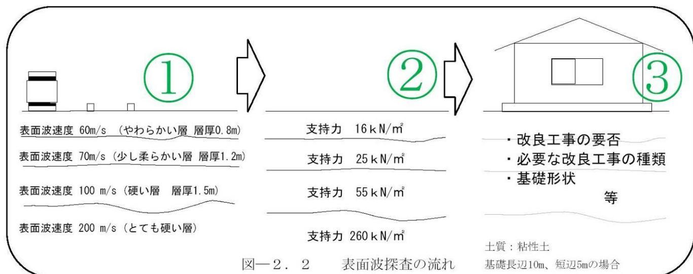
調査の結果、測定位置毎に地盤の硬軟（速度値）、境界深度が得られます①。この結果から、支持力を算出します②。これらの情報が予定構造物の基礎構造設計並びに施工に関する基礎資料となります③。
